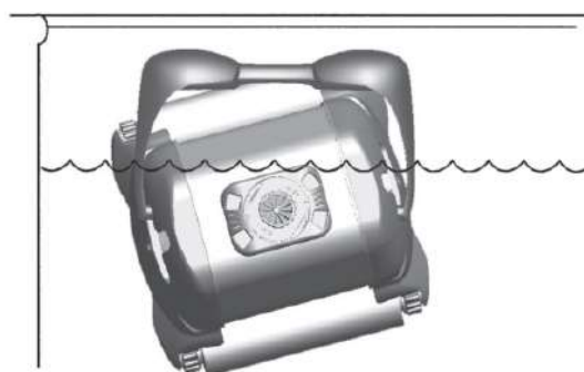
Nieprawidłowa wysokość linii wodnej
